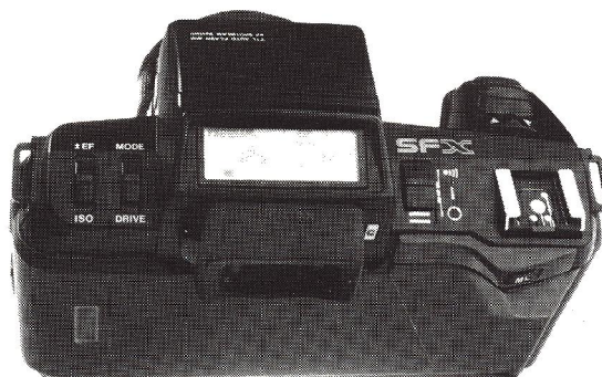
LCD-displayet og flashskoens har byttet plads. Det viste sig at være et stort plus i praksis.
